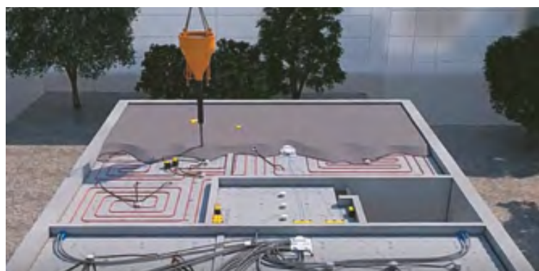
Image 3D d'une dalle Smart Cast en cours de coulage
